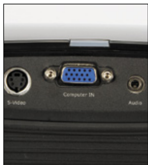
Desde la conexión VGA (Sub-D15) se puede conectar una fuente de vídeo al PC.
