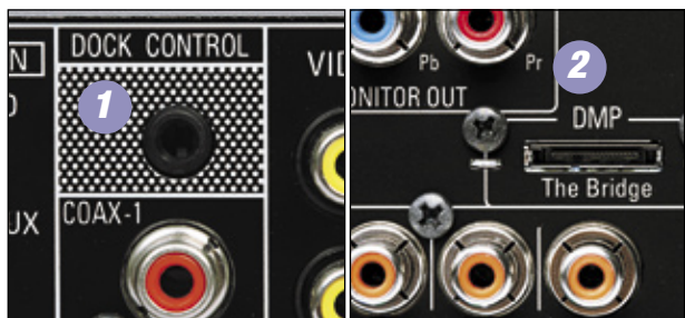
Para conectar un iPod a una base Dock, algunos equipos cuentan con una entrada Dock Control 1 o DMP 2.
