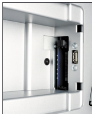
En la entrada Common Interface se puede conectar un adaptador PCMCIA para insertar las tarjetas de televisión por pago.
